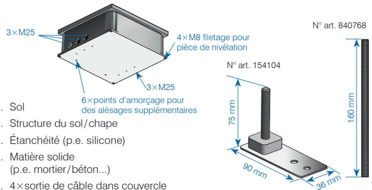
**FONTO 8308**, Boîtier de prises souterrain avec couvercle et sortie de câble, fermé IP65, 240x240x95 mm **aluminium anodisé**, niveau réglable +/- 5 mm
